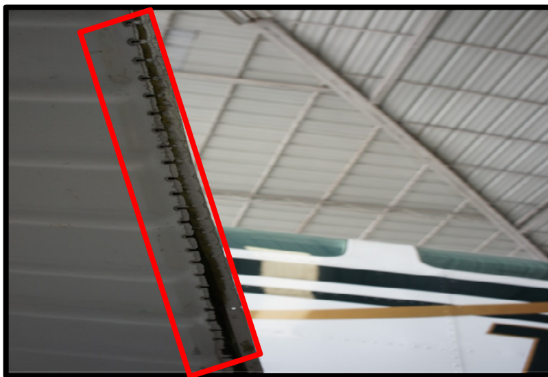
Fotografía No. 12 Vista de los daños en el flap izquierdo.
