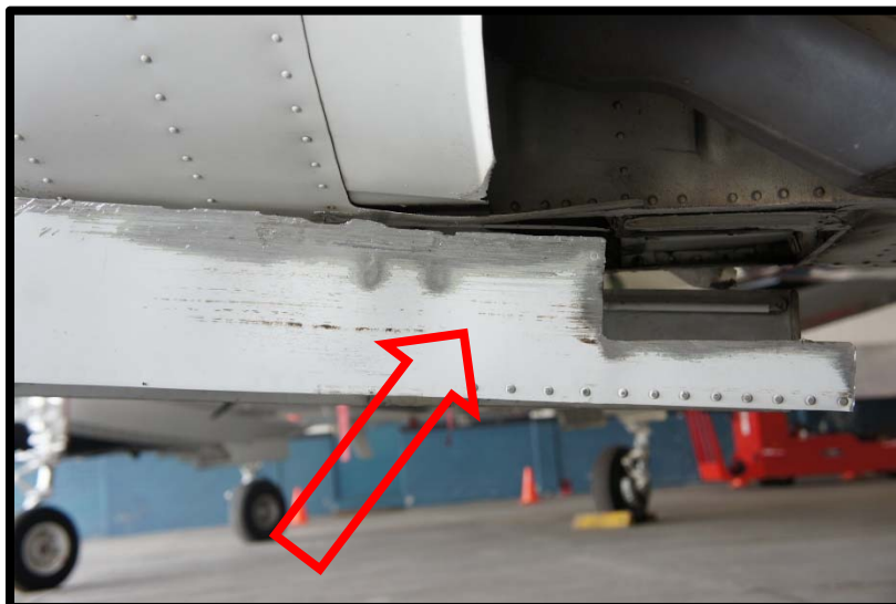
Fotografía No. 9 Compuerta del tren de nariz con daños.
