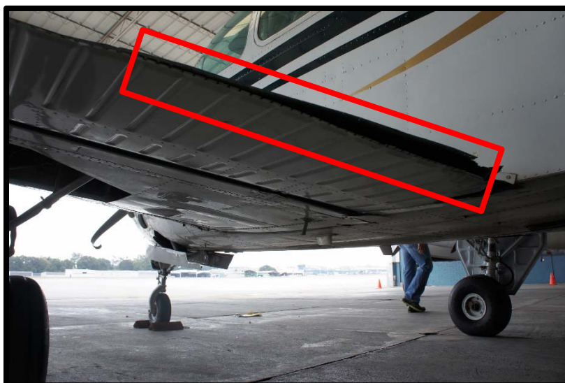
Fotografía No. 10 Daños en el flap del plano izquierdo.
