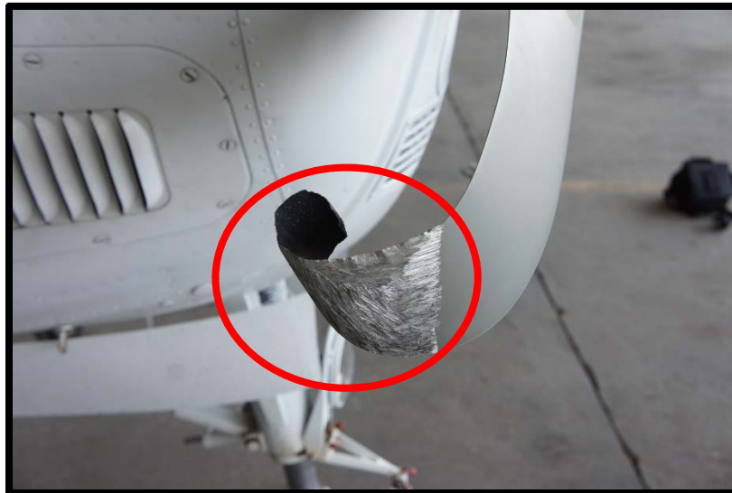
Fotografía No. 7 Hélice con el aspa dañada.
